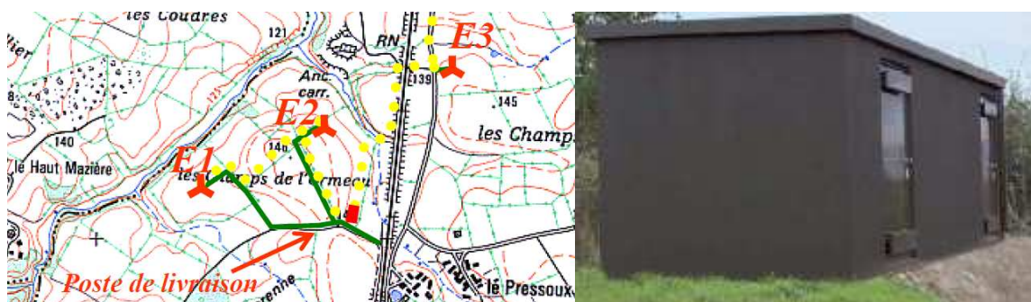
Figure 5 : Localisation et modèle du poste de livraison
